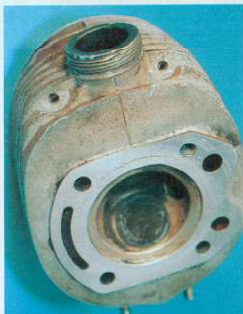
Angegriffen: Das Auspuffgewinde – eine Schwachstelle – ist nicht mehr das beste...
