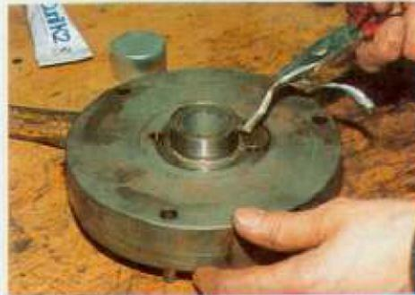
...wird mit Hilfe eines „Bechers“ (oben) über den Stumpf getrieben, der Rand abgebördelt
