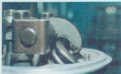
Unbedingt prüfen: Drücken die Kipphebel auf die inneren Ränder der Federteller?
