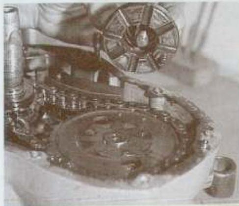
In das Sackloch der Motorentlüftung wird später der Abzieher eingeschraubt...
