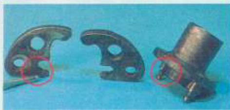
Finden sich in den Fliehkraftregler und an den Zapfen stufenförmige Kanten, ist der Regler hin
