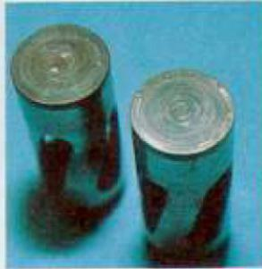
Müll: Selbst leichte Ausbrüche auf den Stößel-Gleitflächen führen bald zur Zerstörung der...
