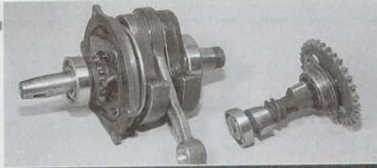
Einbaufertig: Nocken- und Kurbelwelle liegen vollständig bestückt bereit. Derweil wird das Motorgehäuse auf der Herdplatte kräftig erhitzt
