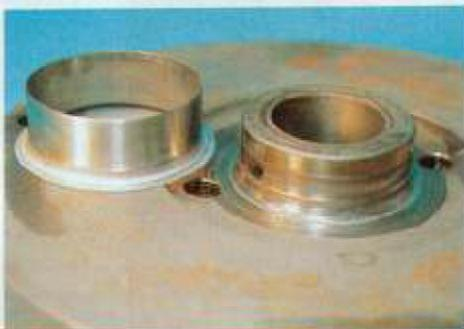
Der Simmerring hat sich in den Stumpf der Schwungscheibe eingearbeitet. Die Blechhülse
