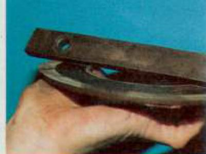
Ein planes Flachisen offenbart, ob die Kupplungsdruckplatten tellerförmig...
