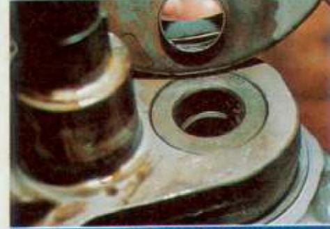
Das Ölschleuderblech ist voller Schlamm; es wird – wie die Kurbelwelle – ausgetauscht
