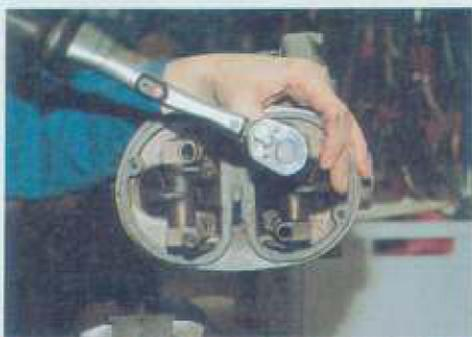
Zylinderkopf über Kreuz mit 45 Nm anziehen, Ventile einstellen – fertig ist das Werk!
