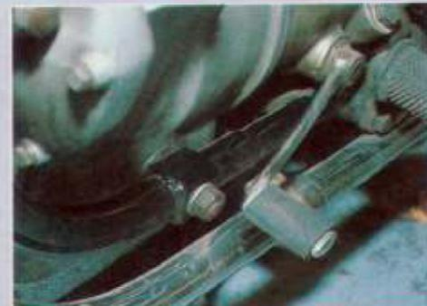
Die Schalen der Motorhalterungen lösen sich mitunter von den Rahmenrohren
