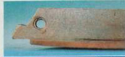
...verformt sind. Bildet sich zur Mitte hin ein keilförmiger Lichtspalt, ist Ersatz fällig
