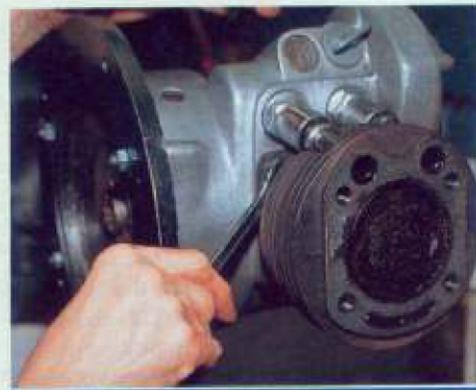
Für die Zylinderfußmutter muss man sich einen 14er Ringschlüssel zurechtschleifen
