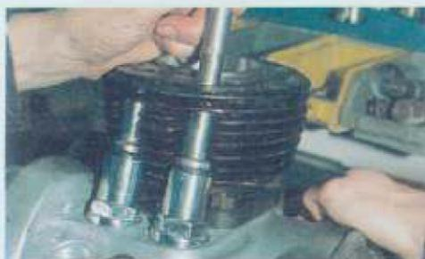
Per Dorn werden die Hüllrohre nachgeschlagen, bis sich die Gummis etwas aufspreizen
